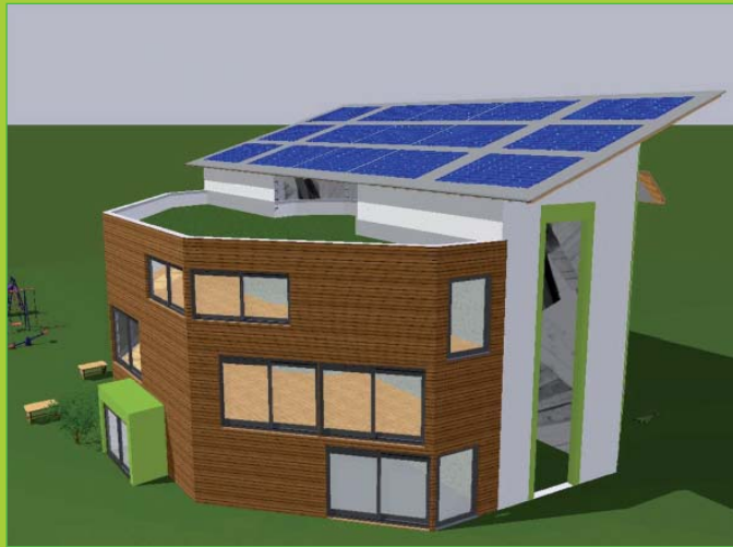
Geplante Photovoltaikanlage des ökologisch optimierten Neubaus.
